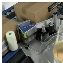
Il sistema Videojet 9550 è in grado di stampare e applicare etichette direttamente anche alle velocità più elevate: non è più necessario suddividere il lavoro su due linee!
